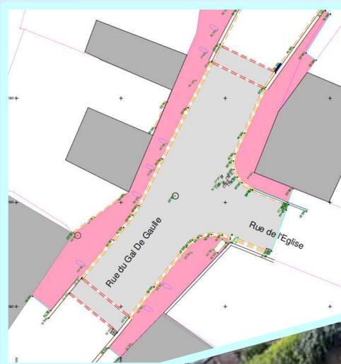
Les dimensions des plateaux sont normalisées. Malheureusement, un défaut de raccordement entre la chaussée côté Sud et la pente du plateau a été constaté lors de la réception. L'angle d'attaque de la pente était trop agressif. Eiffage Route, qui avait réalisé ces travaux, a corrigé ce défaut au mois d'octobre à ses frais. Le raccordement côté Nord était parfaitement conforme.
